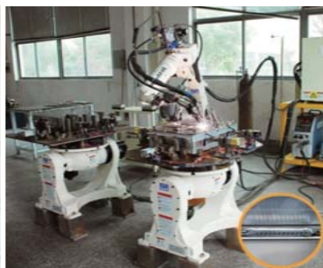
溶接ロボット
